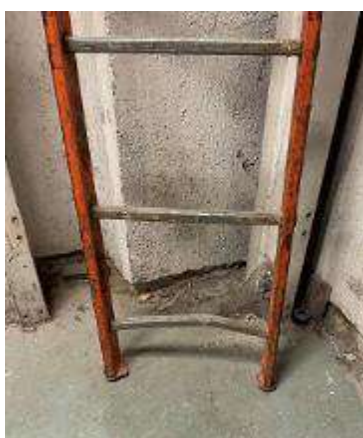
DDCT - Équipement de travail en mauvais état
